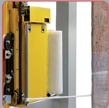
● Sistema pinza taglio del film estensibile con inserimento del lembo finale nell'ultimo avvolgimento di film. Utilizzabile anche con film macroforato.
