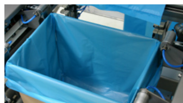
Dépose de saches contrôlée
